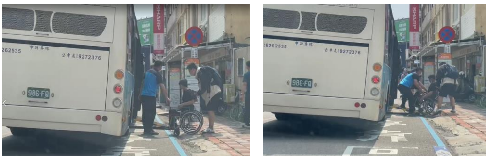
圖 4.1-2 無障礙服務部分缺失情形-預留距離不足
