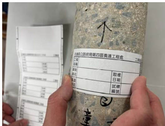
將易碎貼紙及RFID標籤一併 黏貼至混凝土鑽心試體側面
