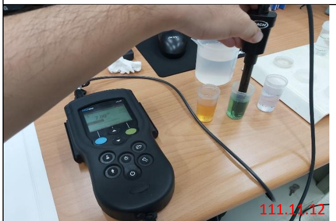
校正維護-手持 sensor 校正
