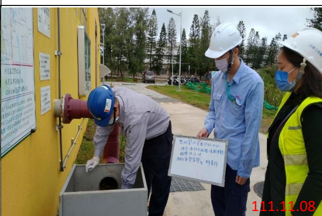
檢驗人員進/放流水採樣作業
