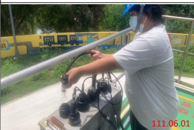
一般維護-水質監測儀器清洗
