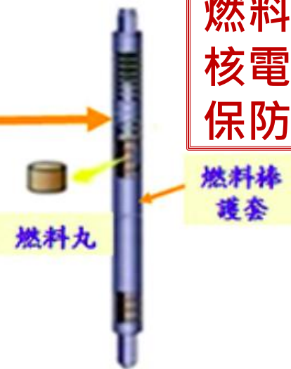
燃料棒 燃料丸置於鋁金屬 護套管內
