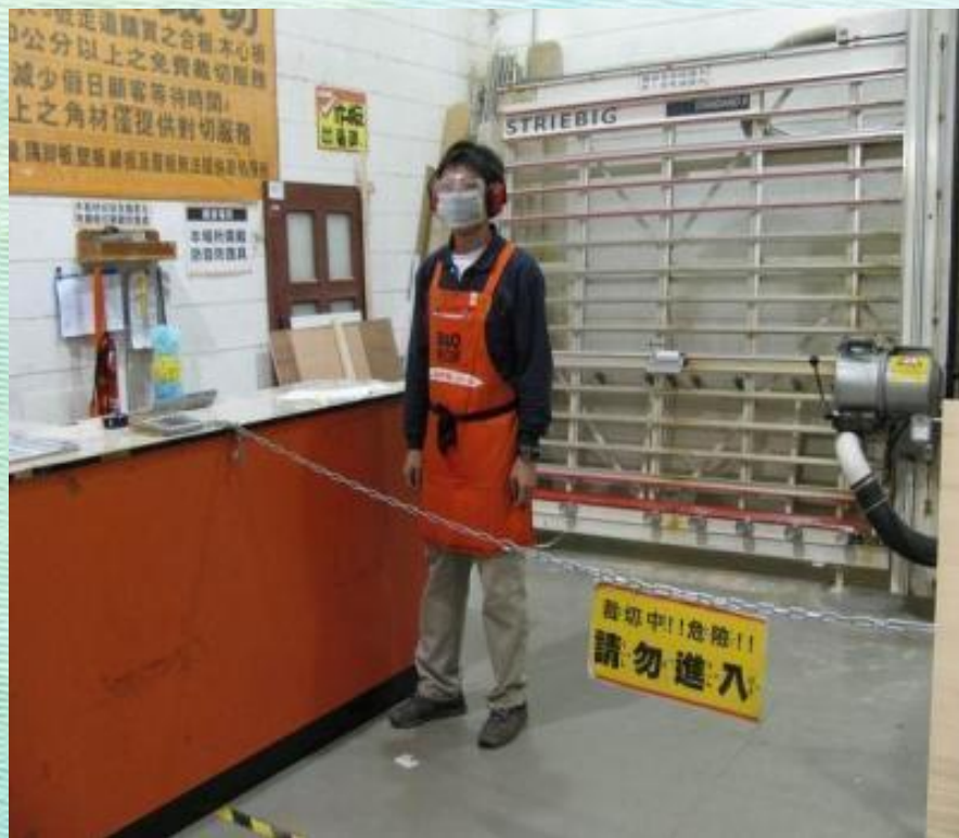
裁切區員工防護設備
