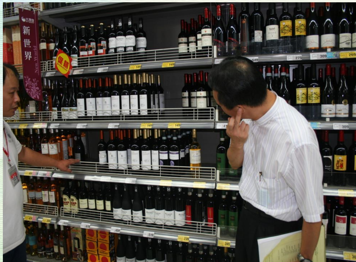
大潤發一、二館 加裝網架與塑膠板防落
