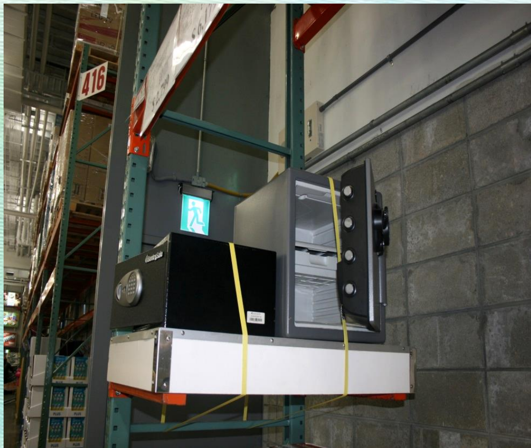
貨物架基底固樁與防護掉落之措施
