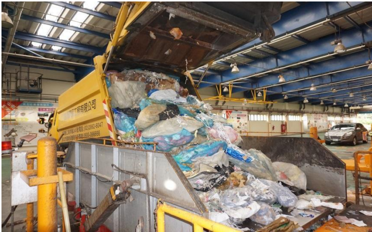
將垃圾車駛入廠區內倒出垃圾
