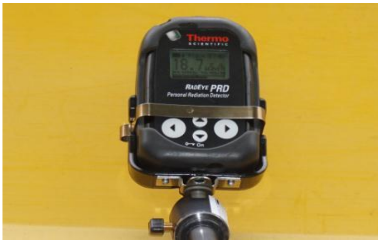
垃圾車一側表面劑量率最高值為 18.7 \mu\text{Sv/hr}
