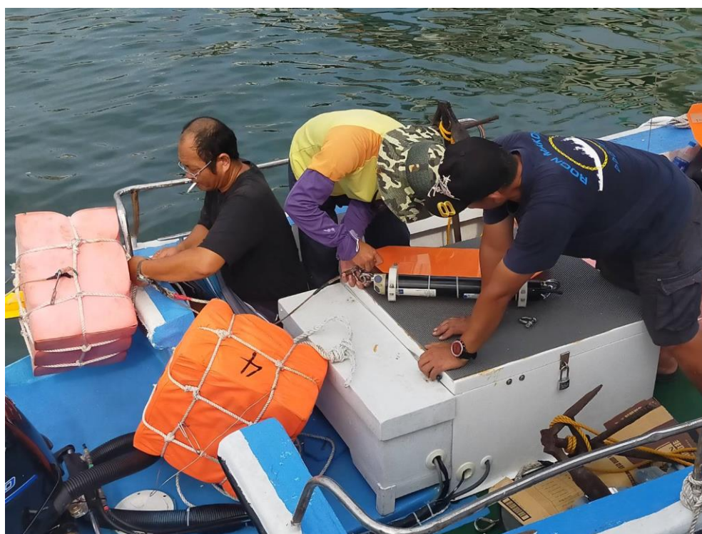
圖 3-7. 海流儀佈放前的組裝與檢查作業
