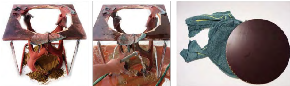
把布料釘在一個木板上，該板在整個生產過程中保持不變，因此每張桌子都具有相同的直徑，盤子是桌面的模具
