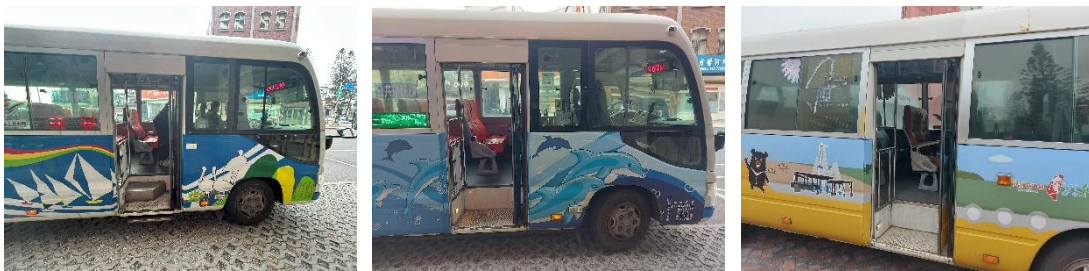
圖 4.1-5 車輛階梯邊緣顏色區分概況
