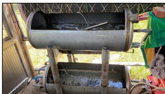
圖 16. 望安鄉岩川養場將報廢的臥式熱水器改造為海膽養殖槽
