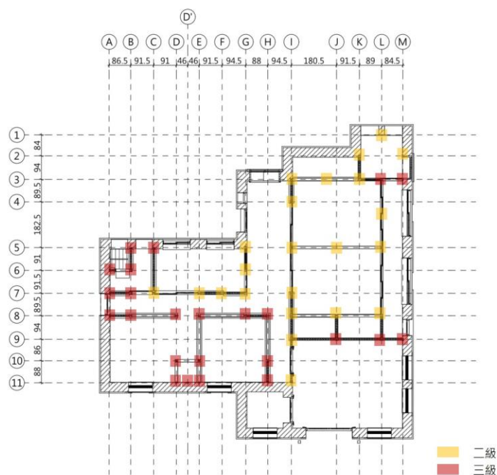
圖 78 木柱損壞平面圖
