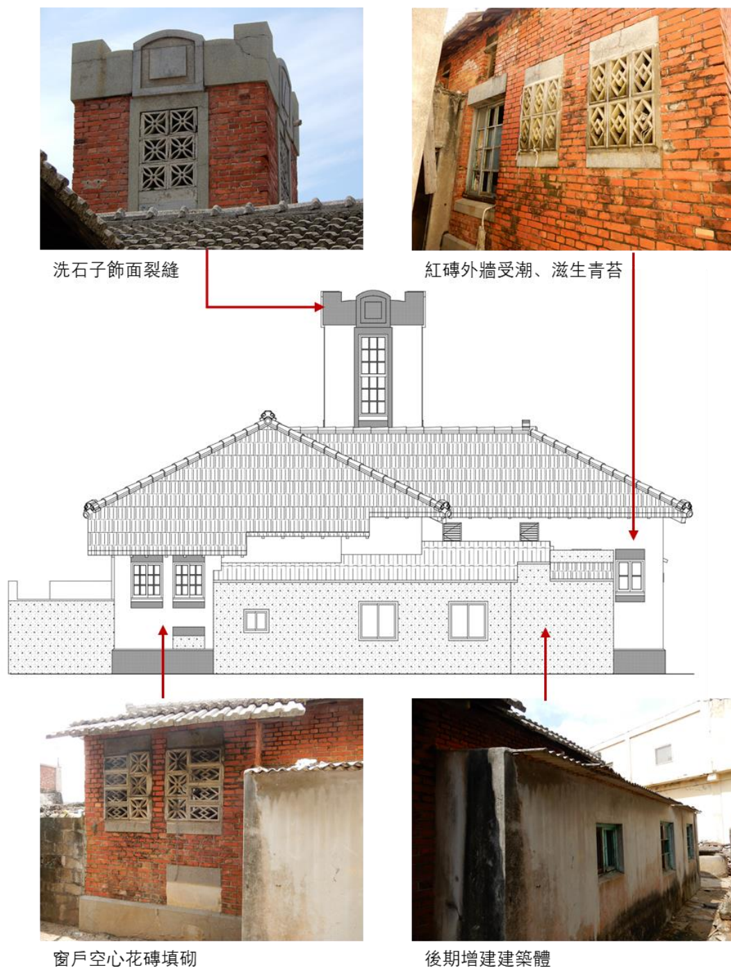
圖 81 北向正立面損壞立面圖
