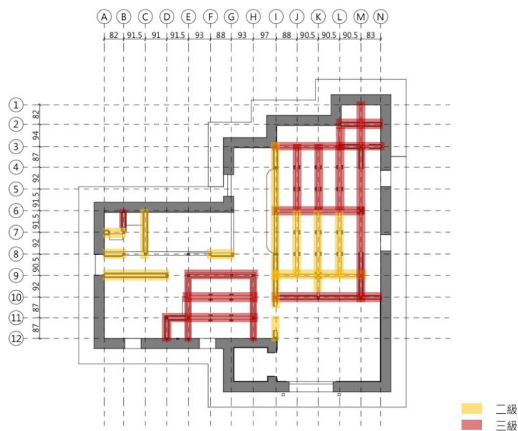
圖 75 土台及大引損壞平面圖
