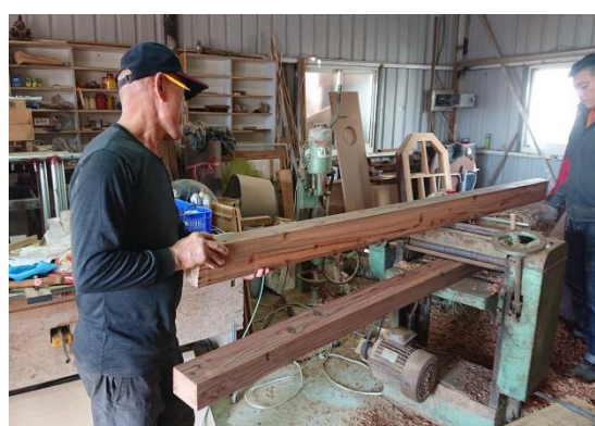
照片 53. 第二次刨木，調整正確的厚度
