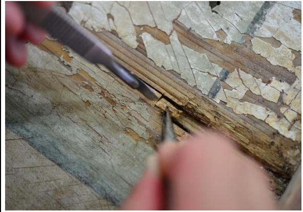
照片 1. 木材碎片取樣示意圖。
