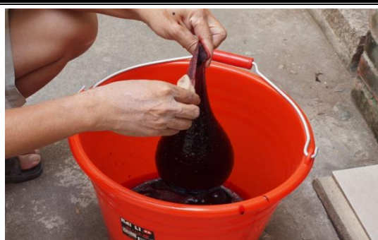
照片 21a 用絲襪過濾豬血中的雜質及油脂
