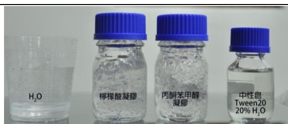
照片 7. 本實驗所使用的清潔劑: 20%中性皂、丙酮苯甲醇凝膠、檸檬酸凝膠、水
