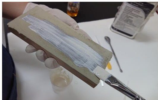
照片 22c 鋅白礦物顏料粉以及由桐油+石油精(white spirit)延展劑均勻調混來作為底色
