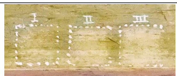
照片 8. 三種清潔劑的清潔效果。 I. 20%中性皂、II.丙酮苯甲醇凝膠、III.檸檬酸凝膠
