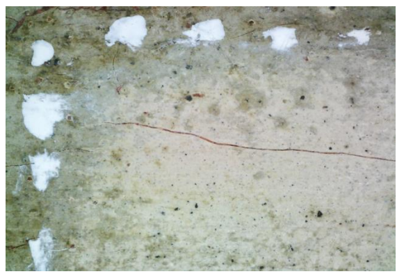
照片 12. 數位顯微鏡-檸檬酸凝膠局部放大攝影
