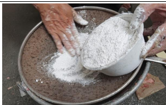
照片 21c 過篩牡蠣殼燒製而成為石灰粉
